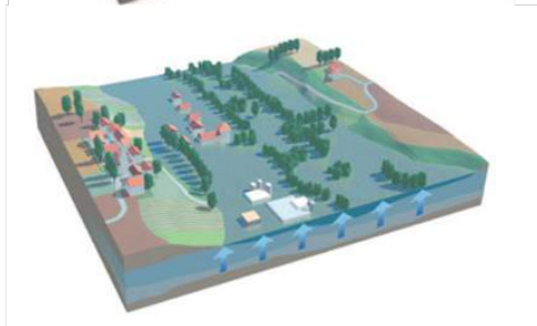
Remontée de nappe
